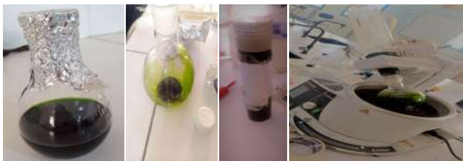
Figure 30 : La concentration d'extrait récupéré par évaporateur rotatif
