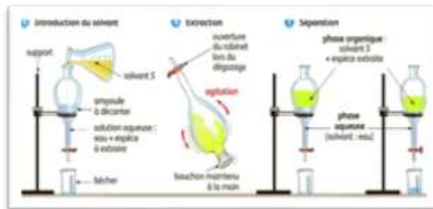
Figure 03 : méthode extraction liquide-liquide ( Samate,2001 ) .
