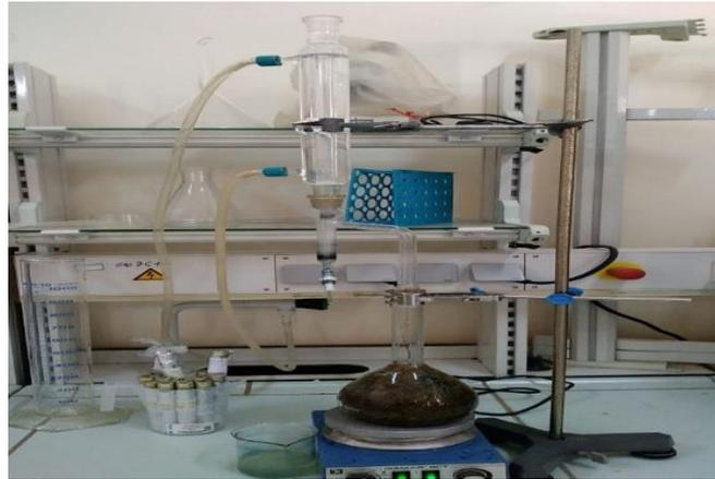
**Photo 04:**Montage d'hydrodistillation pour l'extraction des huiles essentielles.
