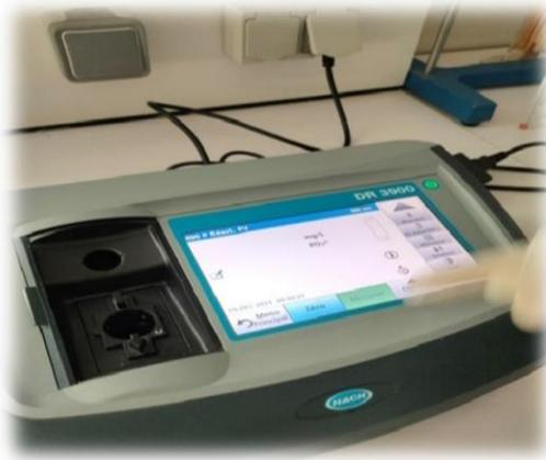
**Figure 17** : spectrophotomètre DR 3900
