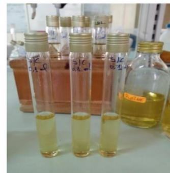
Figure 22 : Recherche et dénombrement streptocoques fécaux dans l'eau
