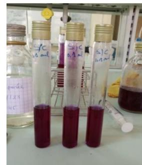
Figure 21 : Recherche et dénombrement coliformes fécaux dans l'eau
