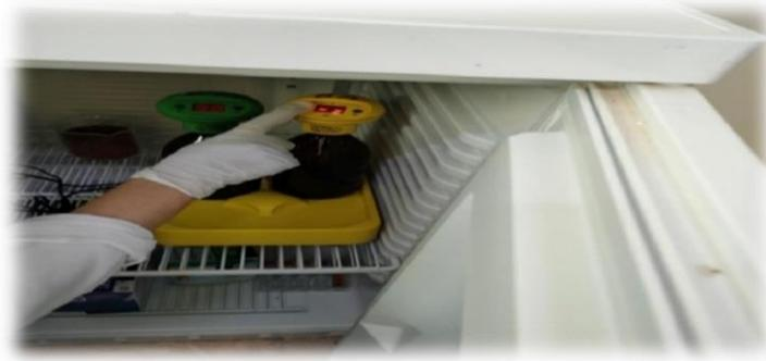
**Figure 16** : flacon à D.B.O avec oxytope (Source : ONA , 2023)
