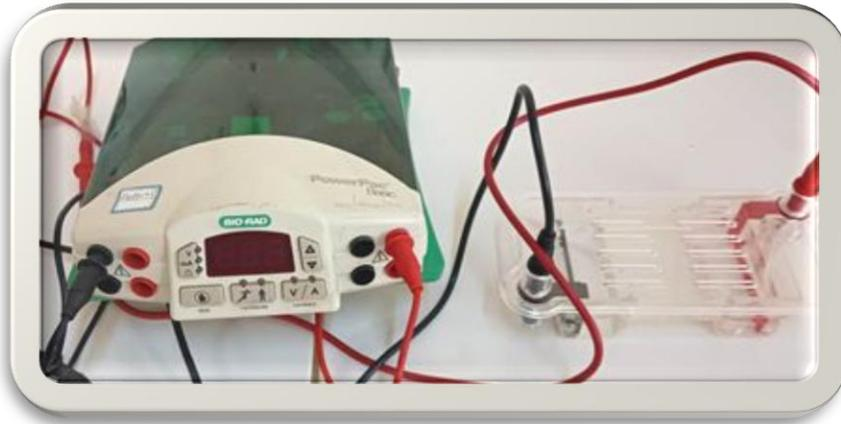
**Figure 12:** Configuration du générateur d'électrophorèse et du système d'électrophorèse
