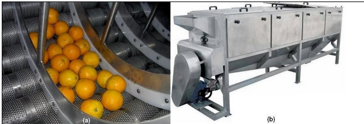
Figure 8 : Machine à expression à froid (a) grattage des épicarpes d'agrumes (b): machine à extraction par expression à froid des huiles essentielles d'agrumes (Meissa et anfel,2020)
