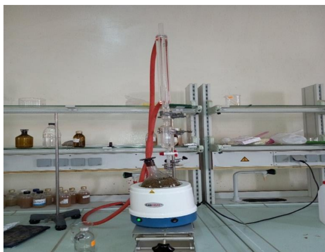
Photo 06 : Montage d'extraction de l'huile essentiel de Thymus ciliatus
