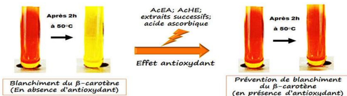
Figure 13 : Principe du test de blanchiment du β-carotène.
