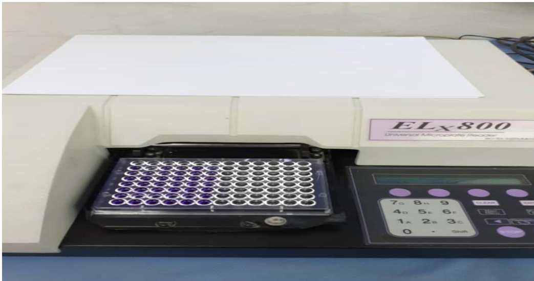
Figure 19: Lecture des résultats de la formation d'un biofilm par le lecteur des microplaques
