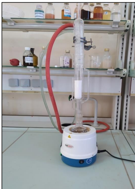
Figure24 : L'extraction A chaud A l'aide de l'appareil de soxhlet.
