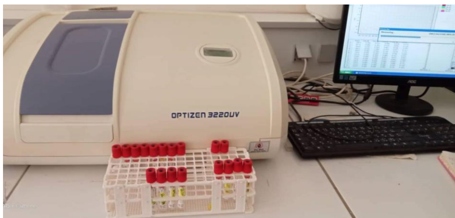
Figure 34 : la lecture des extraits de stérol diluée par spectrométrie UV-Visible entre 230 et 300.
