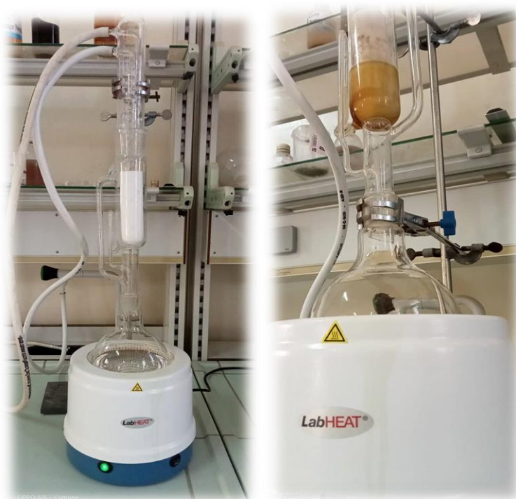
Figure 17: préparation des extraits éthanoïques par Soxhlet
