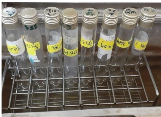
Figure 28 : incubation dans le bain d'eau à 85°C pendant 1h.
