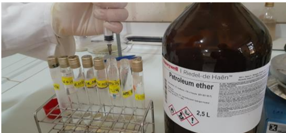
Figure 29 : extraction des stérols par l'addition du mélange d'eau distillée stérile et éther de pétrole.
