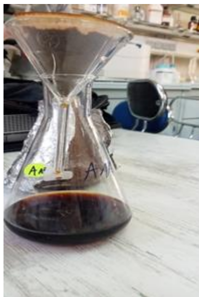
Figure 19 : filtration du produit des soxhlet
