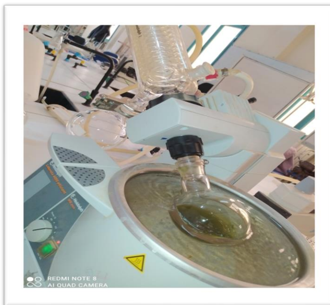
Figure N°21 : Procédure d'évaporation par rotavapeur
