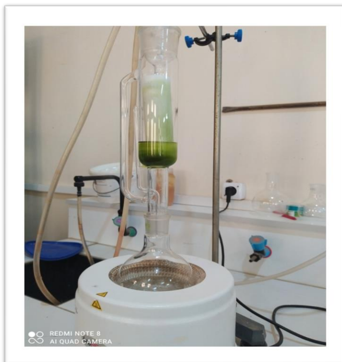
Figure N°20: Procédure d'extraction par Soxhlet
