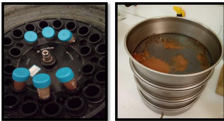
Figure 21: Extraction des spores des champignons endomycorhiziens selon la méthode de Gerdemann et Nicolson (1963).
