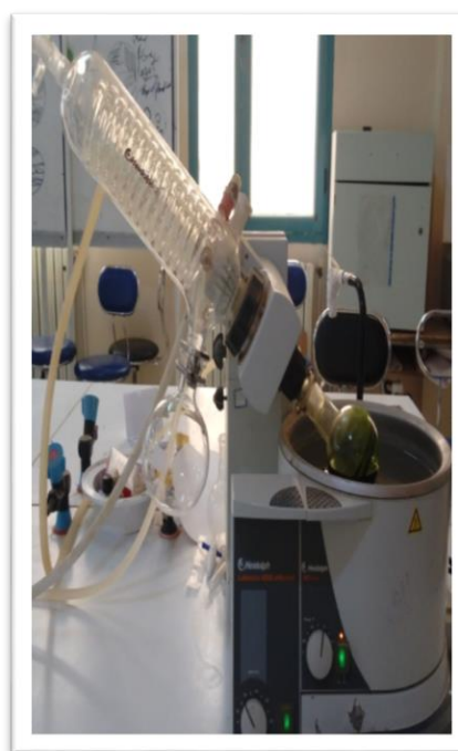
B- évaporation du solvant par l'évaporateur rotatif.
