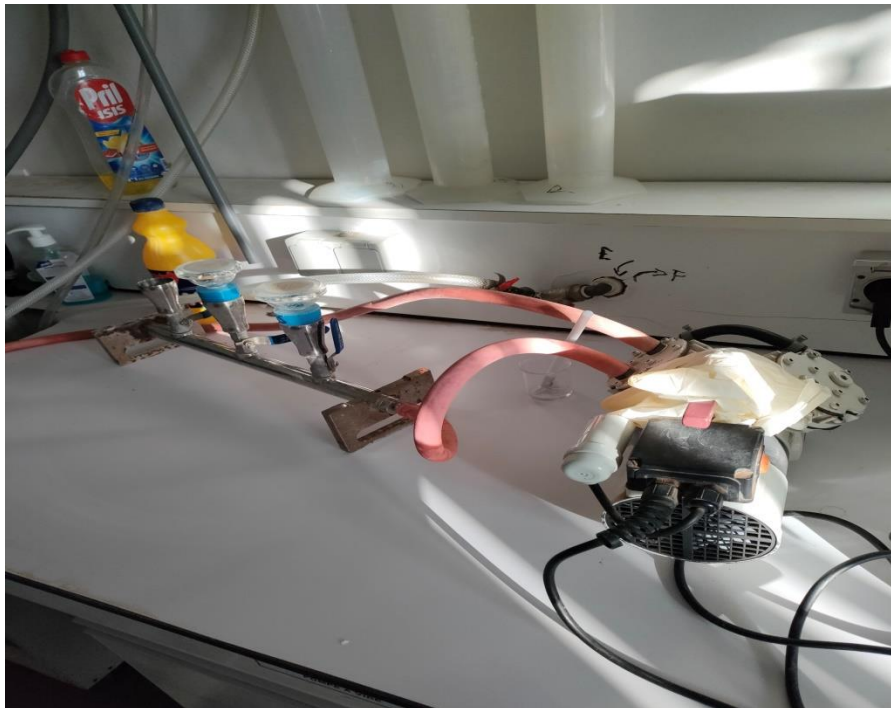
Fig. 17 : Dispositif de filtration sous vide
