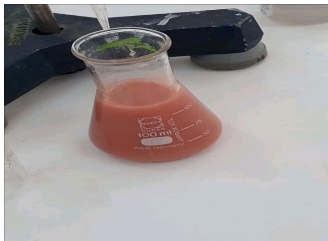
Figure 12: Observation du virage de couleur lors du titrage des chlorures par l' \text{AgNO}_3 .
