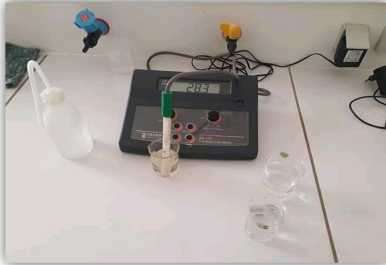
Figure 10: Prise de mesure de la conductivité électrique par un conductimètre modèle Hanna.
