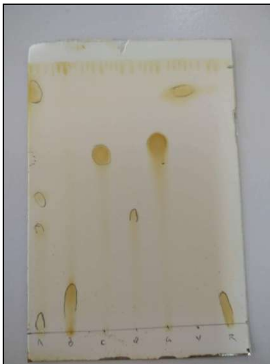
Figure(36) : Chromatographie sur couche mince de extrait méthanolique(Méthanol : Chloroforme : (50/50) (v/v)) des écorces de la plante Henophyton deserti coss.&Durieu .
