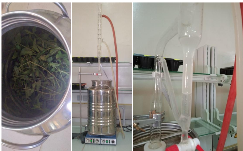
Figure 6: Extraction de l'huile essentielle de M.spicata par entraînement à la vapeur d'eau
