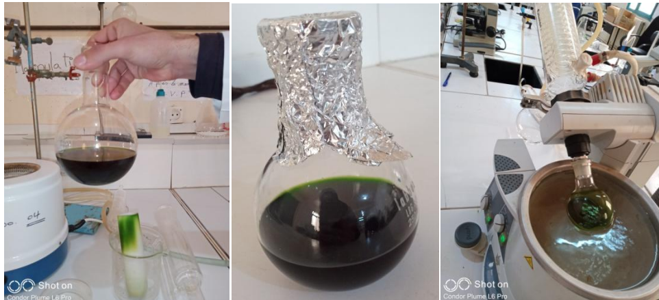
Figure 11 :La concentration d'extrait récupérer par évaporateur rotatif
