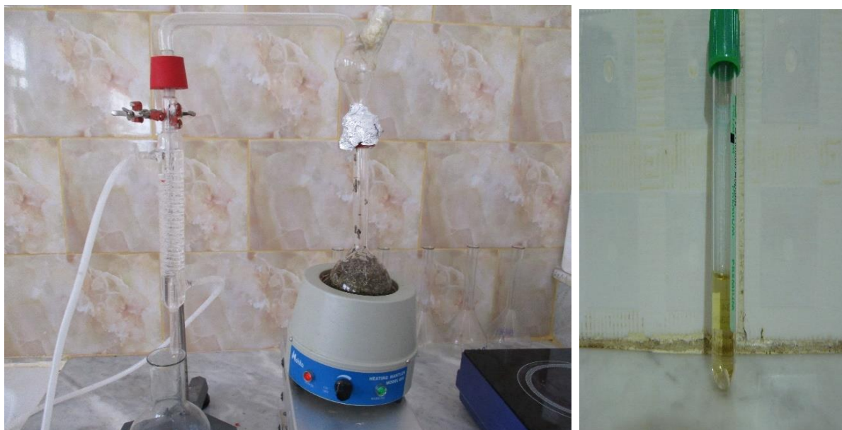
Figure. III.15 : dispositif d'extraction des huiles essentielles des feuilles séchées R. eriocalyx
