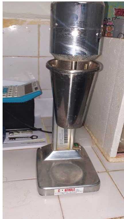
Figure III.8 : Agitateur mécanique à grande vitesse de rotation (de l'ordre de 10000 tr/mn).
