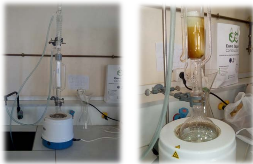
Figure 23 : Montage se soxlet (photo réel)
