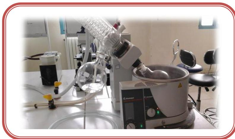
**Figure n°19** : Photographie de séparation de l'H.V par Evaporateur rotatif (Rotavapor)
