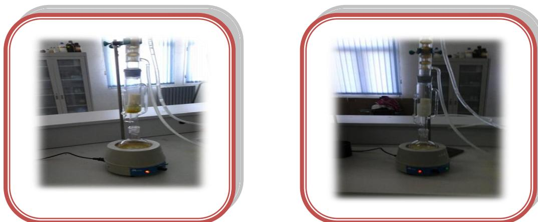
**Figure n°18** : Photographie de l'extraction de l'huile de *Cucurbita pepo* par Soxhlet.
