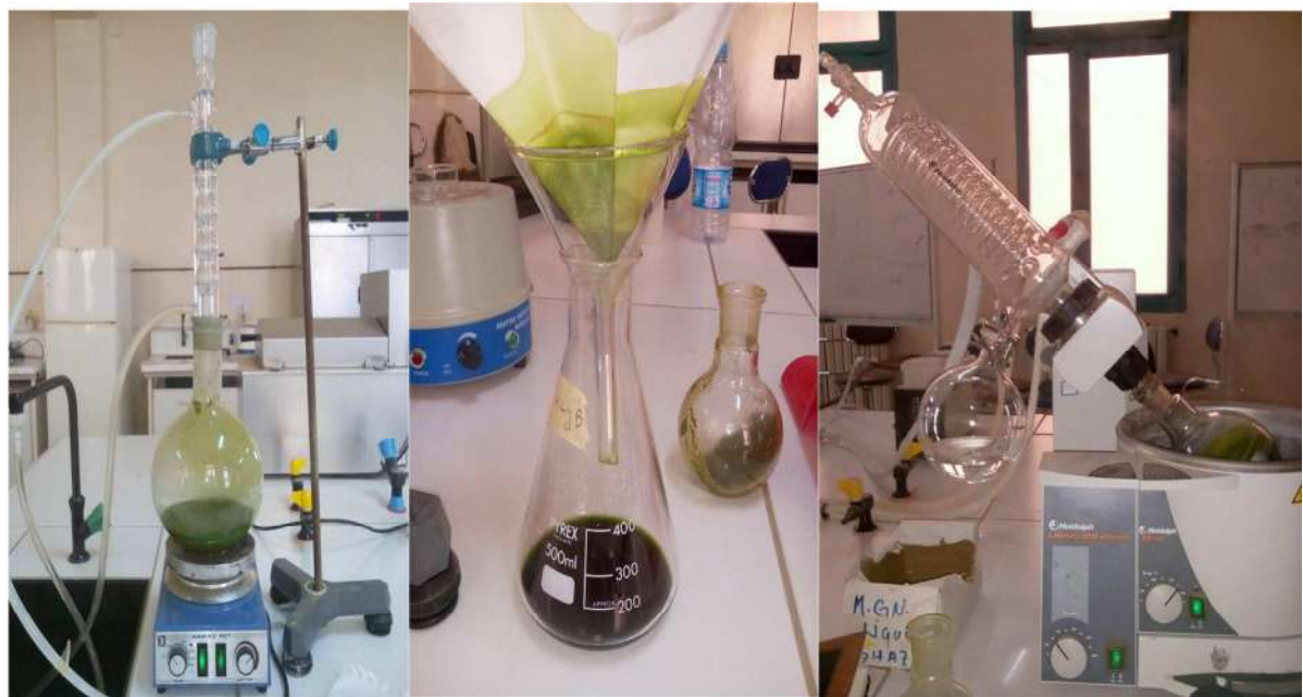
Figure 08 : Montage d'extraction des F.O par Soxhlet (à gauche), filtration de l'extrait (au milieu),et l'évaporation sous vide par rotavapor de type Heidolph (à droite).
