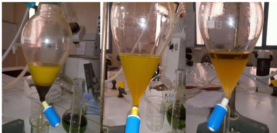
Figure 11 : l'extrait et le chloroforme (à gauche), l'extrait l'Acétate d'éthyle (au milieu), l'extrait et Butanol (à droite)
