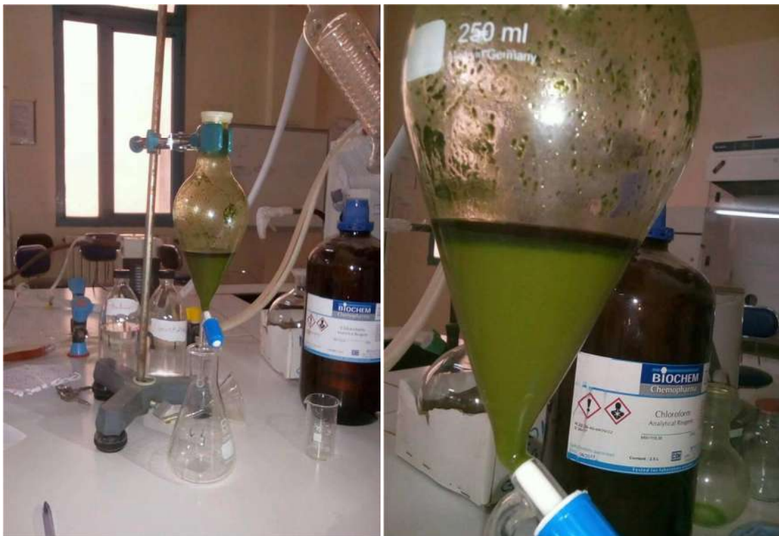
Figure 10 : ampoule à décanter contient l'extrait et le solvant organique (hexane), (à gauche), les différentes phases (phase organique et phase aqueuse), (à droite).
