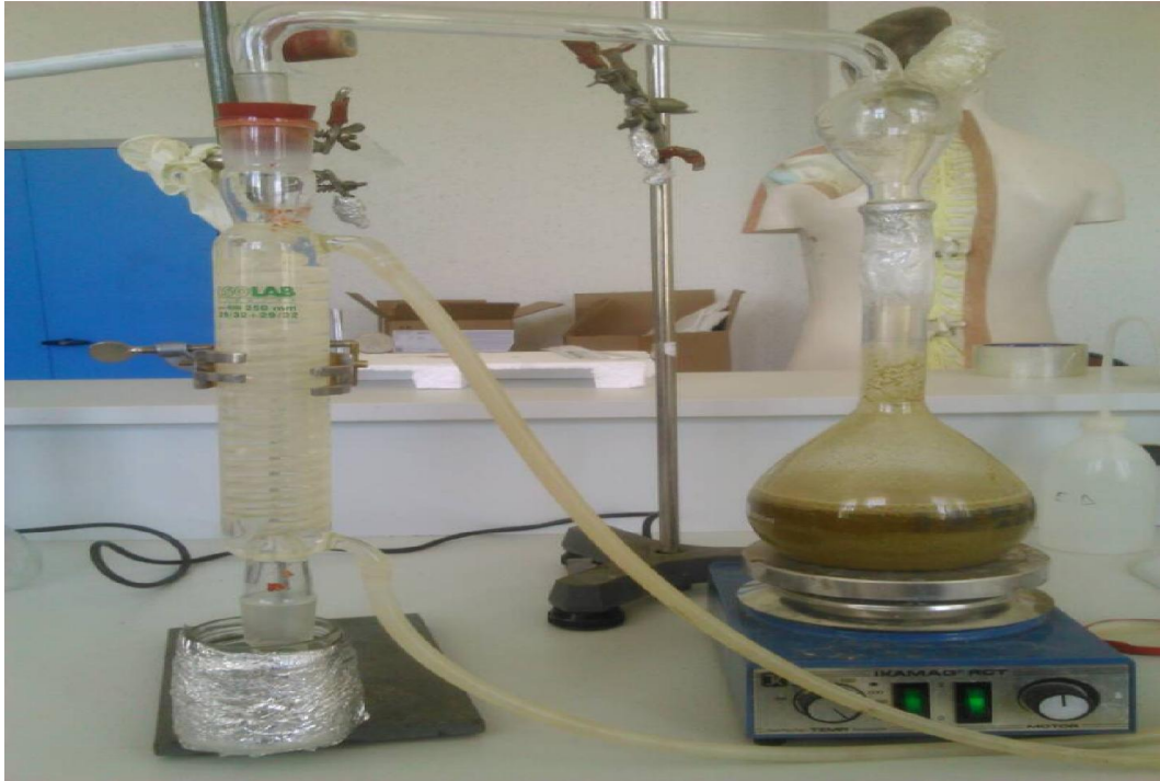
Figure14 : Appareillage utilisé pour l'hydrodistillation del'huile.
