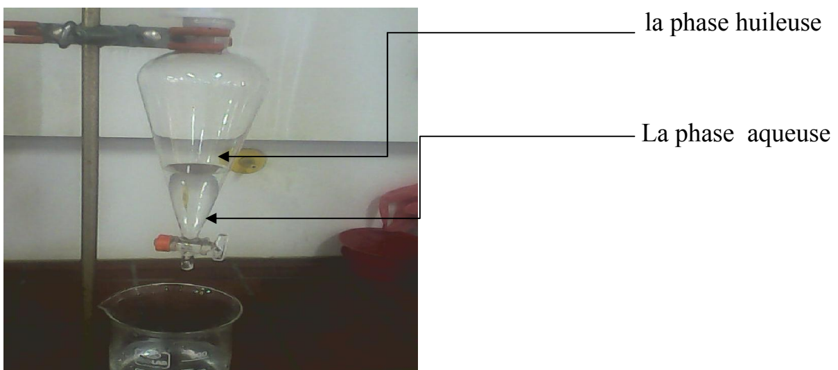
Figure15: séparation la phase huileuse de la phase aqueuse.
