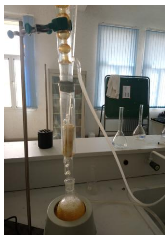
Figure 8 : Montage de l'extracteur Soxhlet
