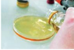
Figure 09 : couler les milieux de culture dans les boîtes de pétri
