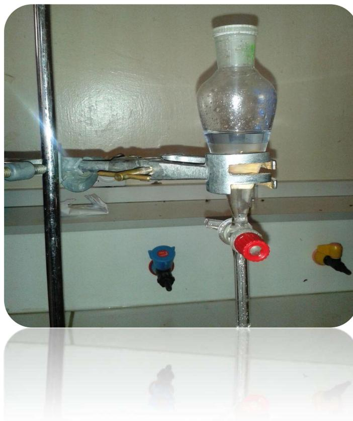
**Figure17** : ampoule à décanter
