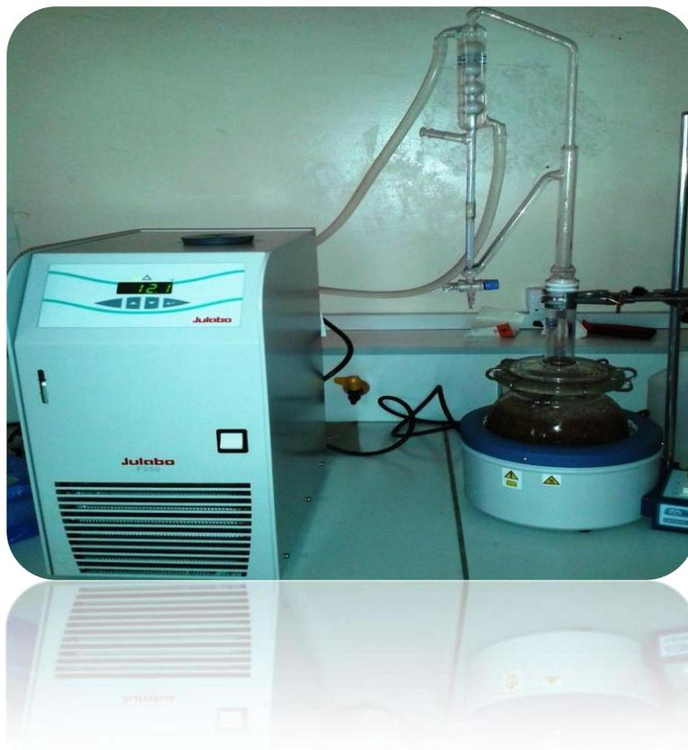
**Figure16** : Montage de l'Hydrodistillateur. (clevenger)
