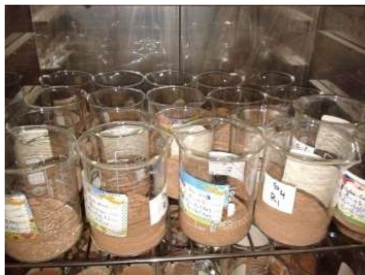
Photo 05 : Mesure d'humidité par séchage dans l'étuve.
