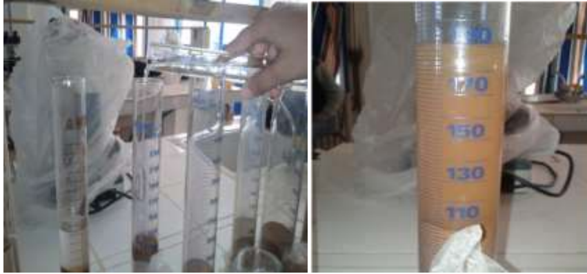
Photo 9 : Mesure de la perméabilité.
