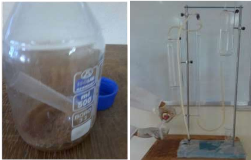
Photo 11: Mesure de calcaire par la calcimètre de Bernard
