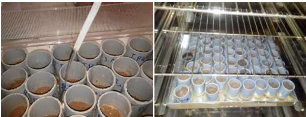
Photo 8 : Mesure de la capacité de rétention.
