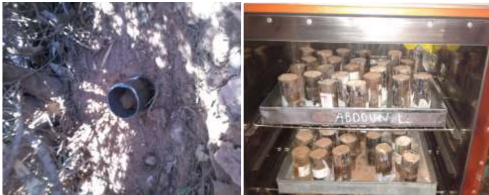
Photo 6 : Mesure de la densité apparente.
