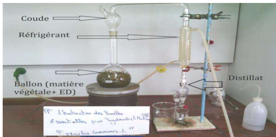
Figure III.5 : Montage de l'hydro-distillateur
