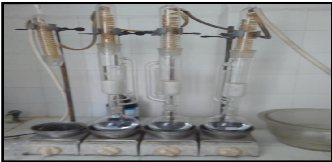
Figure n°63 : Extraction d'huile des graines de F.indica par soxhlet.
