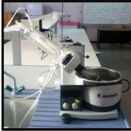
**Figure 34.** L'évaporateur rotatif de type Heidolph G1.
