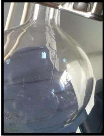
**Figure 33.** La récupération du solvant (eau, éthanol ou méthanol) dans le ballon réceptacle.
