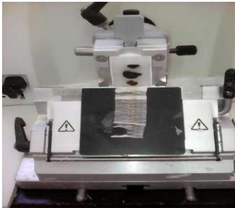
**Figure 26 :** Microtome rotatif de Type Leica 2125.
