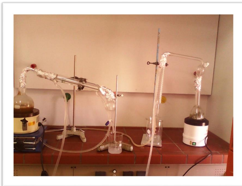
Figure 5: Dispositif utilisé pour l'hydrodistillation
