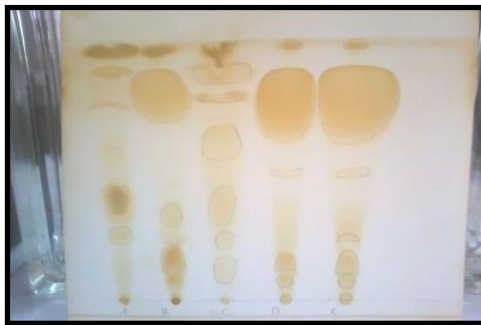
Figure 21: CCM analytique représentative des différentes huiles essentielles utilisées sur plaque de gel de silice développée dans le système solvant un mélange chloroforme : benzène (75:25, v/v)
