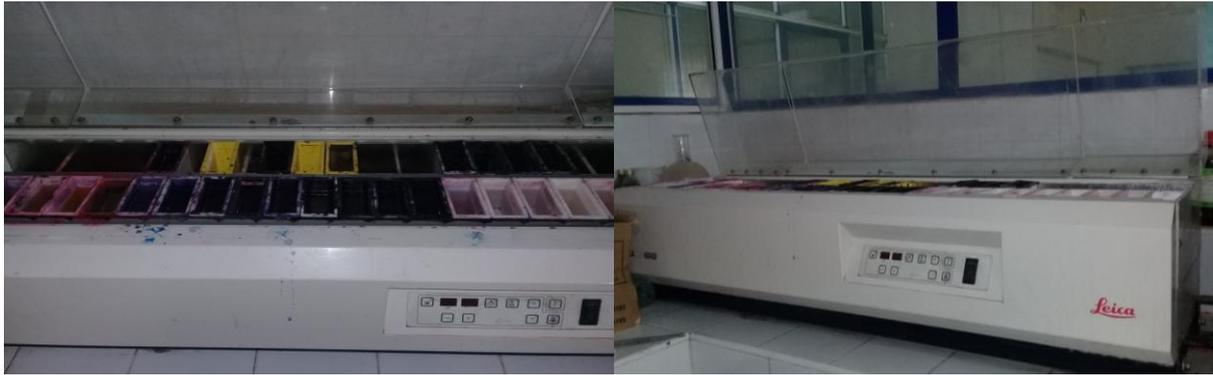
**Figure.14:** l'automate de coloration utilisé
