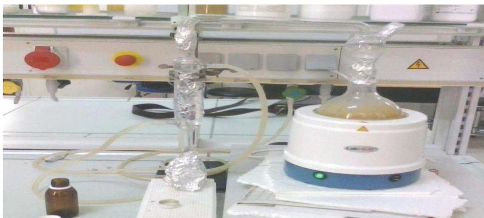
Figure 7 : Montage d'hydrodistillation
