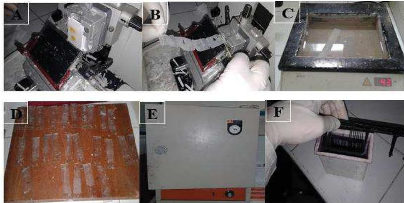
**Figure 18 :** La réalisation des coupes par le microtome.
