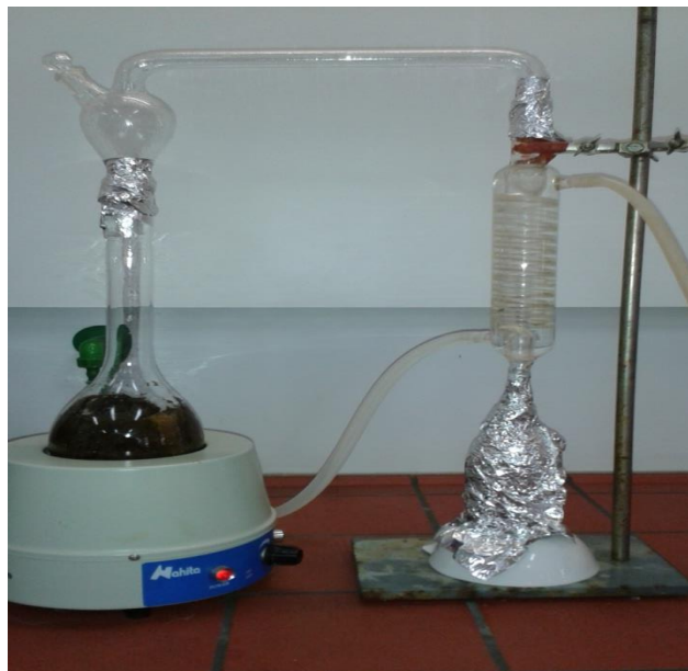
Figure. 09: Montage d'un hydrodistillateur.
