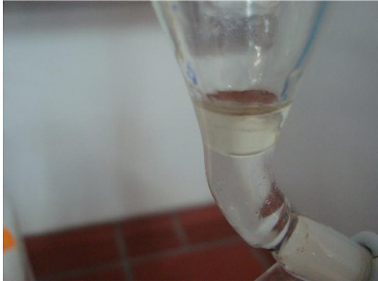
**Figure34** : Récupération d huiles dans l'ampoule à décanter
