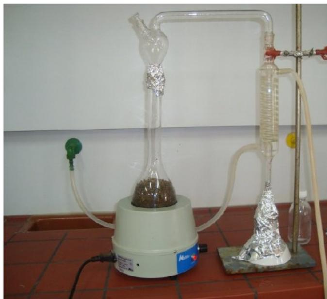
**Figure29: Montage de l'hydrodistillation**
