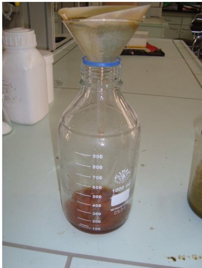
**Figure37** : Filtration de la solution
