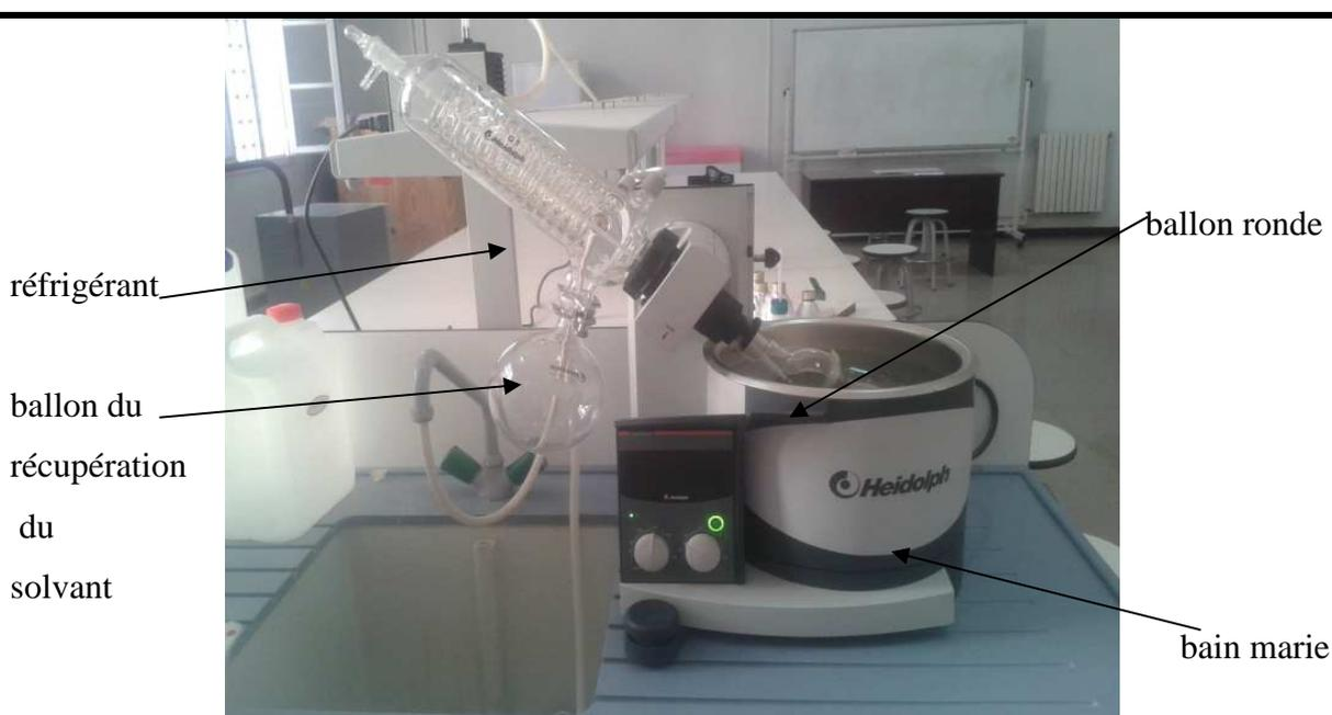
**Figure n° 28** : Montage de dispositif de rotavapor. (laboratoire du centre universitaire du Nàama 2016)
