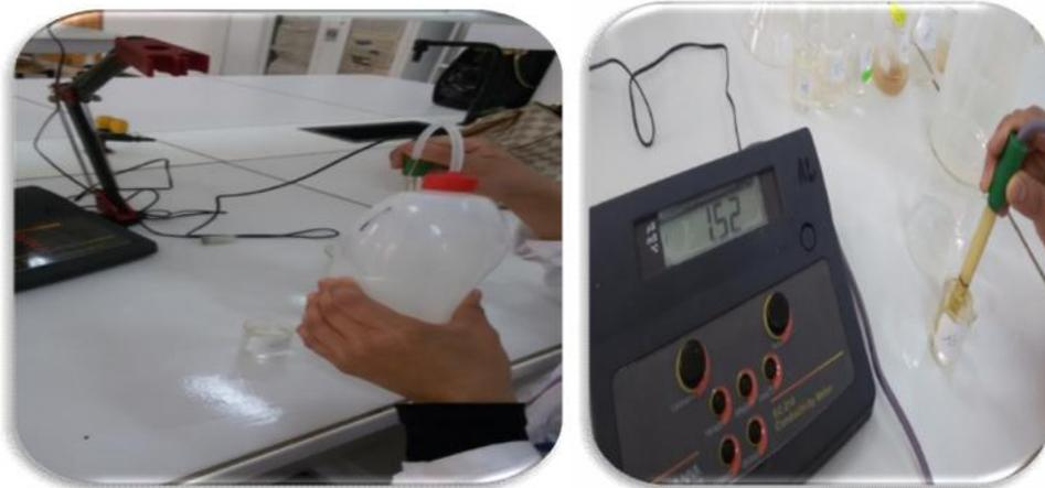
**Figure 32 :** Mesure de la Conductivité électrique
