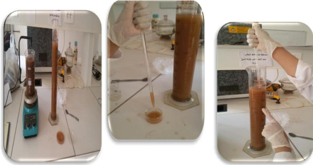
**Figure 30: mesure de la sédimentométrie**
