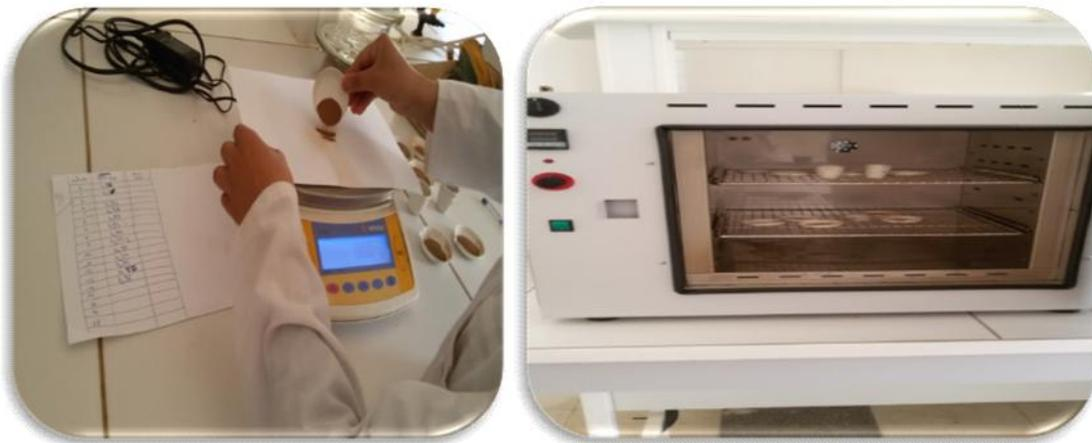
Figure 34 : Mesure de l'humidité
