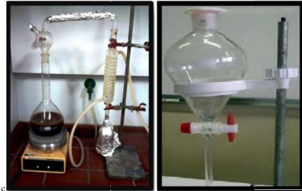
**Figure 07:** Montage de l'hydrodistillation    **Figure 08:** Ampoule à décanter
