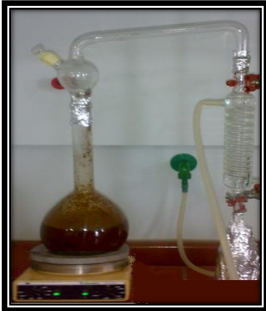
Figure 07: Montage d'un hydro distillateur.
