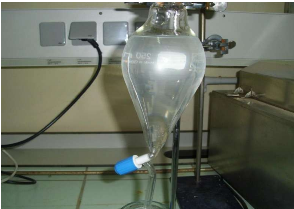
Figure N° 22 : l'étape de décantation
