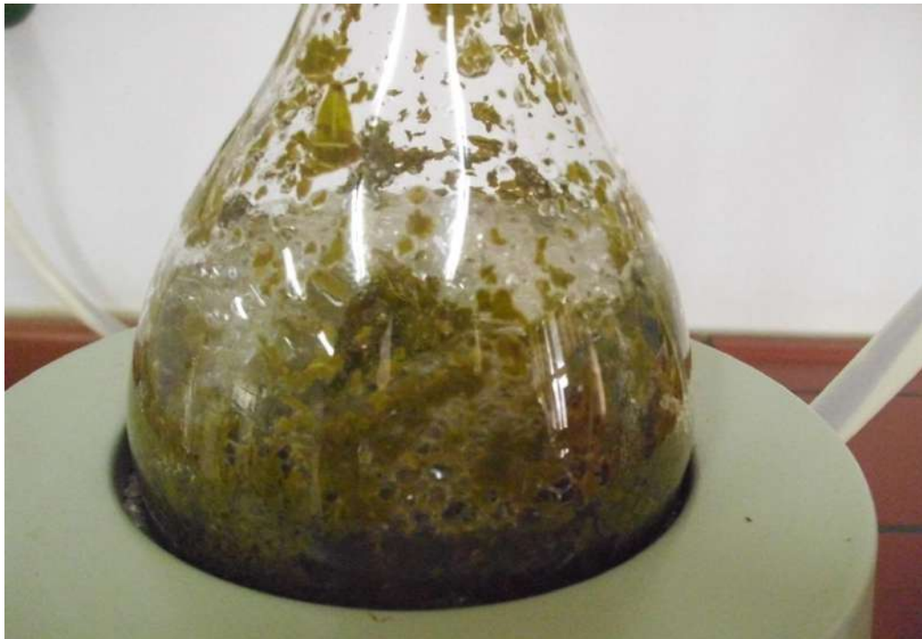
Figure N° 21: l'ébullition d'eau distillée avec les feuilles
