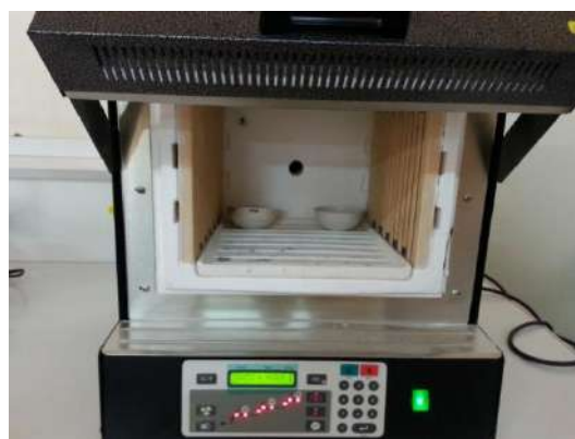
Figure19 : un four à moufle contient des capsules pour mesurer la teneur en cendre.
