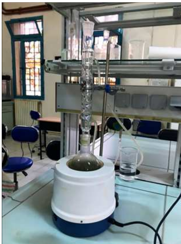
Figure 6: Montage utilisé pour la décoction du matériel végétal
