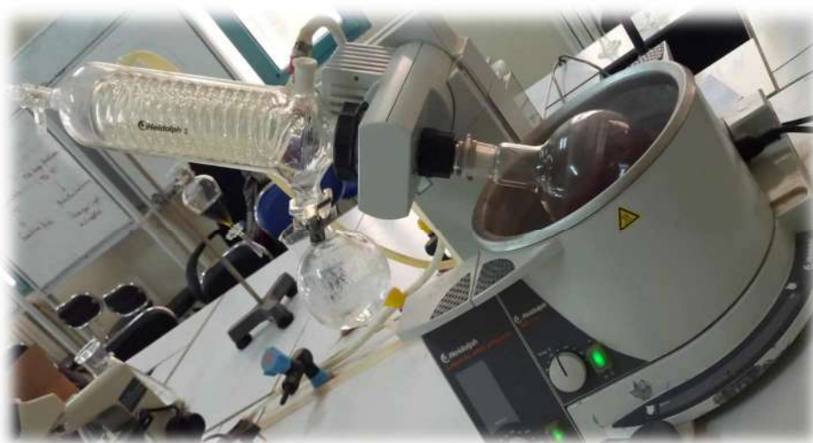
Figure 12 : Montage RotaVap utilisé pour l'évaporation des solvants de l'extrait hydromethanolique
