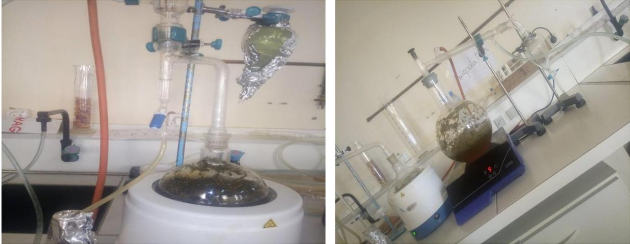
**Figure III-28 Appareil de Clevenger modifié**
