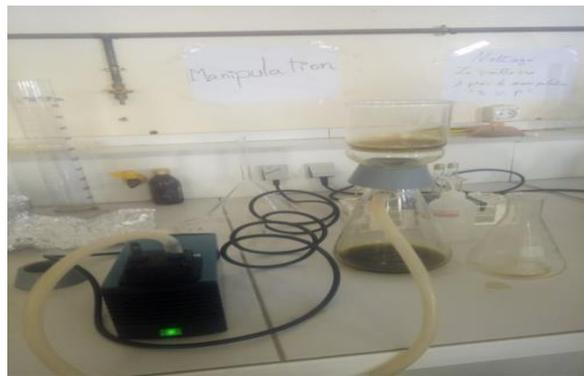
**Figure III-25 Filtration sous vide**
