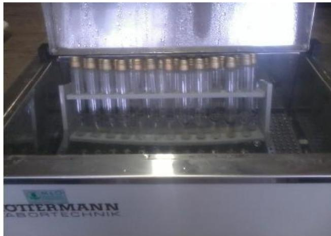
**Figure III-10 Mise en solution des milieux solidifiés.**
