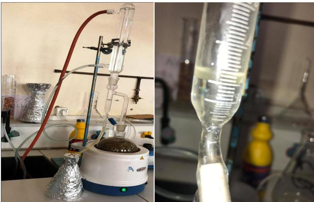
**Figure 24** : montage d'un hydrodistillateur type Clevenger
