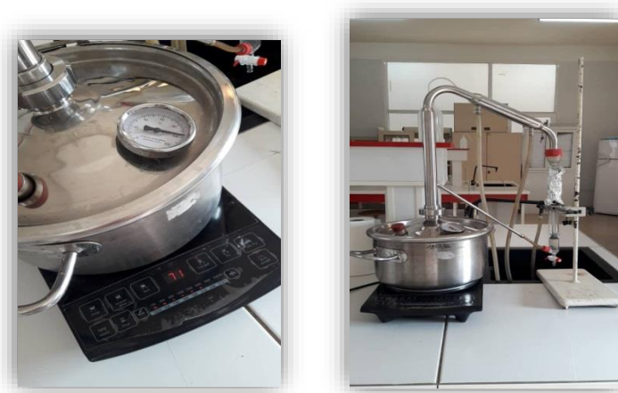
Figure 07 : Autocuiseur adapté pour extraire l'huile essentielle par entraînement à la vapeur
