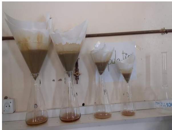
Figure24 : filtration de mélange
