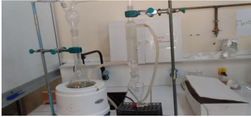
Figure28 :le protocole d'hydrodistillation
