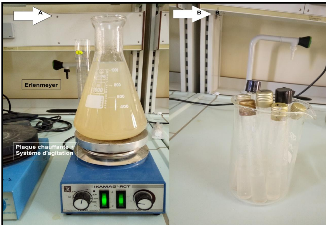
Figure 21 : A : Préparation de la gélose ; B : gélose dans les tubes à vis.
