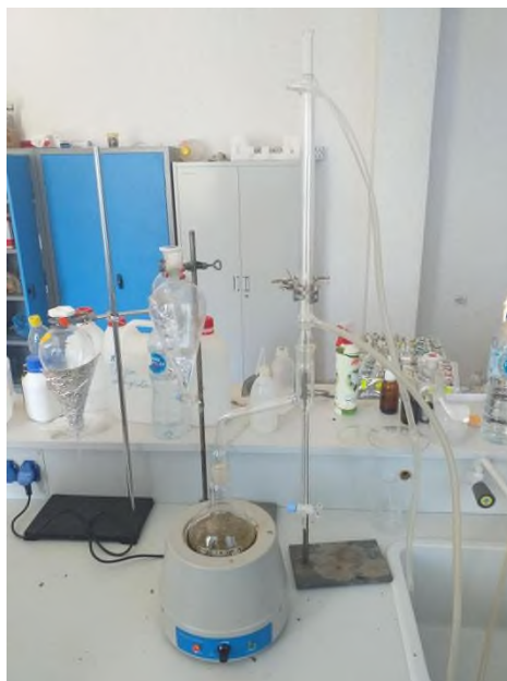
Figure (4): le montage d'hydro-distillation employé pour l'extraction des huiles essentielle
