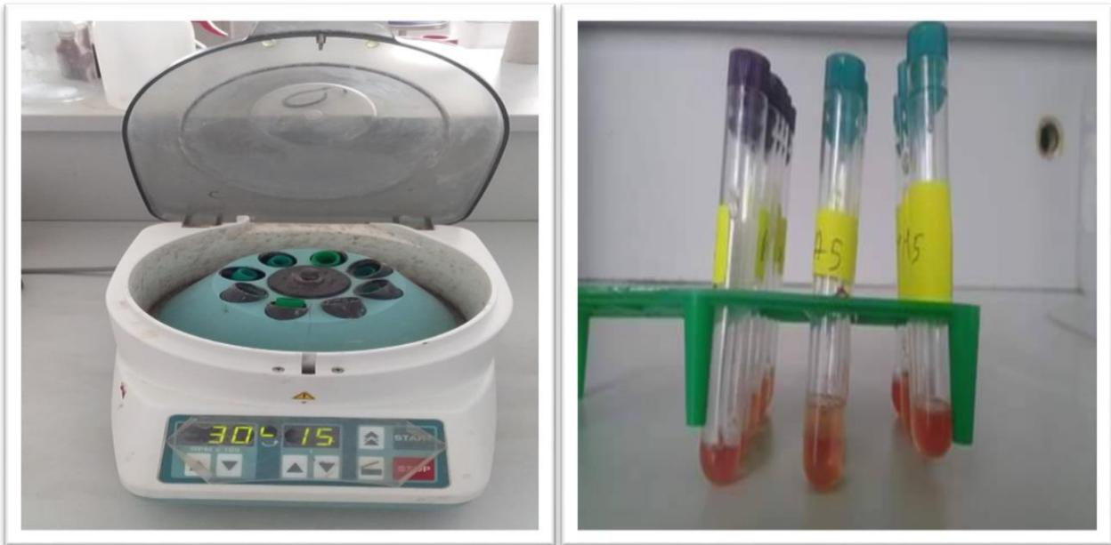
**Figure 6 :** le surnageant obtenue après Centrifugation (3000 tours/min pendant 15 min)
