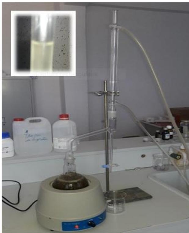
**Figure 06 :** Montage d'hydrodistillation employé pour l'extraction de l'huile essentielle.
